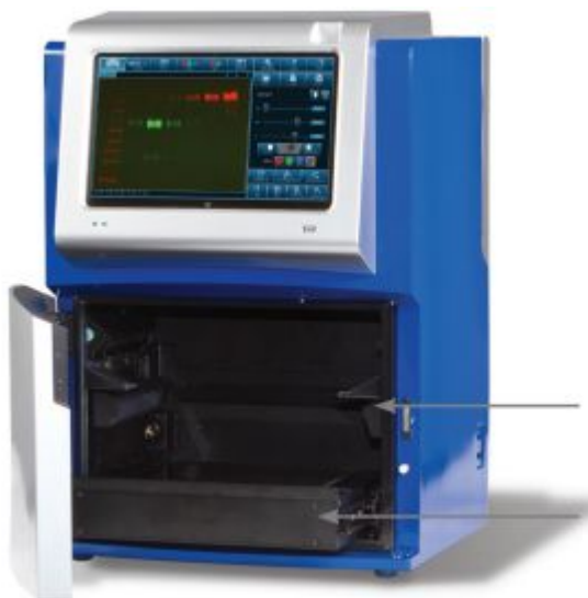
化学发光专用架（仅用于化学发光成像）
