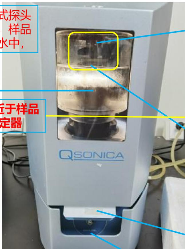
磁吸式顶端，将超声探头固定在超声室
